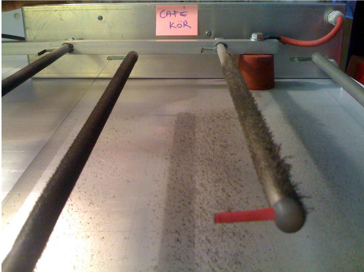
1. ábra: A 2-3. elektródákon por-csúcsokban kiváló nagyobb méretű szennyezések
