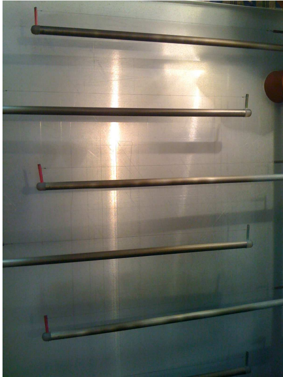
4. ábra: A 10-6. elektródákon kiválóan nagyon finomszerkezetű szennyezés
