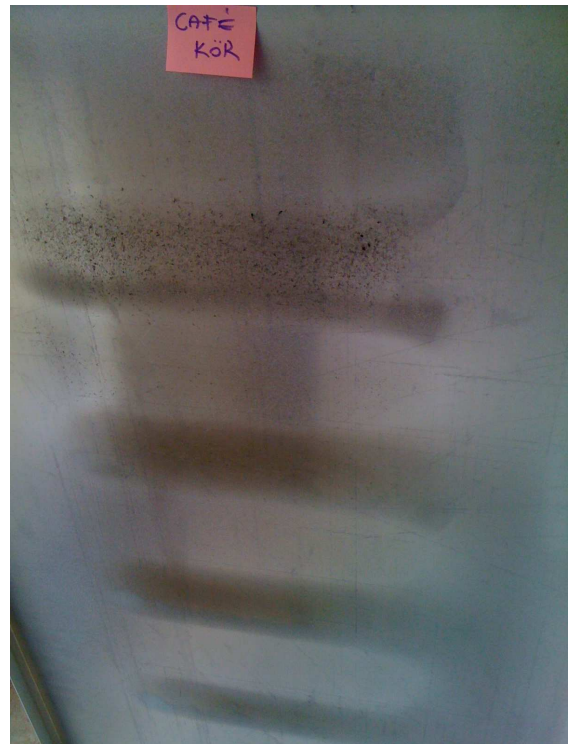
7. ábra: A készülék hátlapján az elektródák mentén képződött korom sávok
