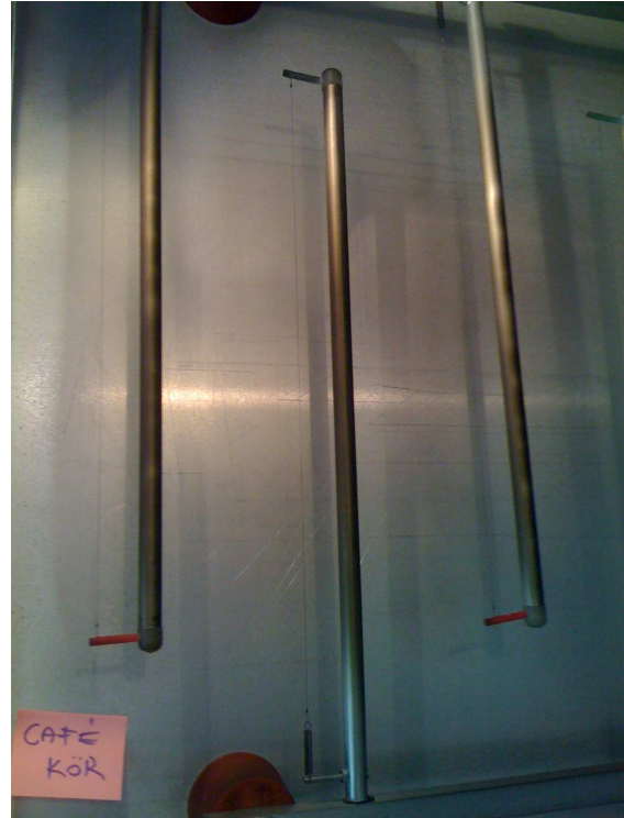
5. ábra: A 10-8. elektródákon látható korom- és gyantaszzerű kiválás
